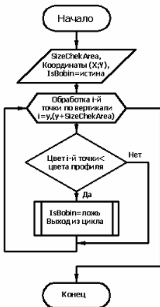
Рис. 1. Блок-схема поиска первой точки профиля паковки
