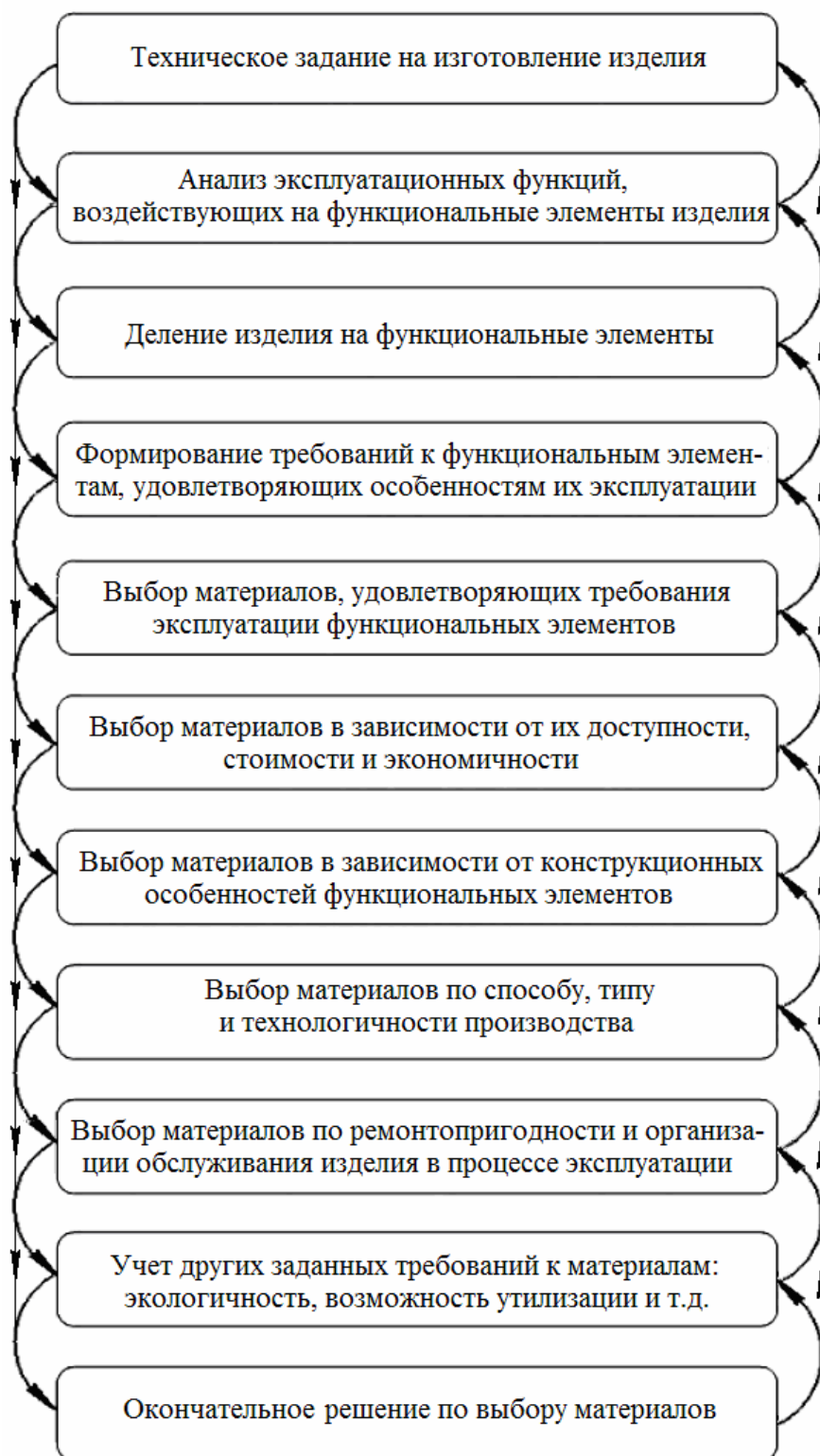
Рис. 1. Модель поискового алгоритма выбора материалов при синтезе ФОТ
