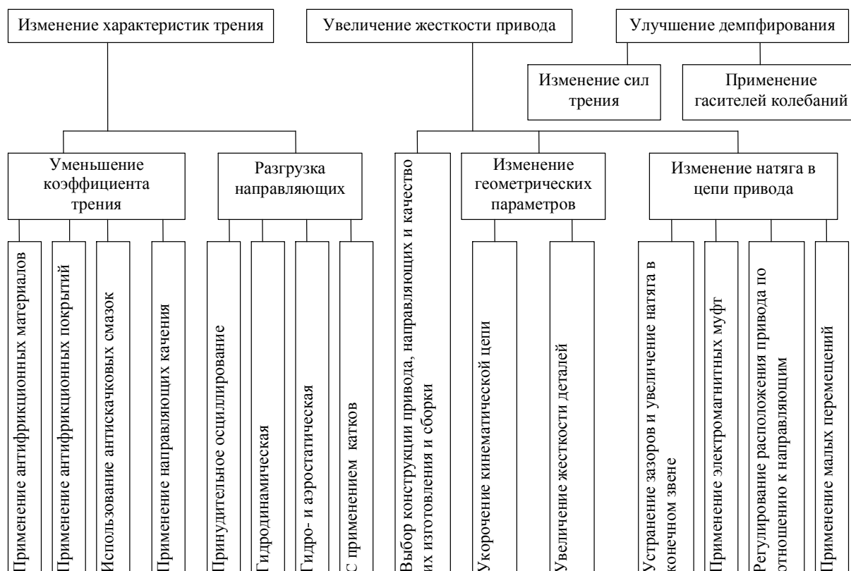
Рис.1. Способы повышения точности позиционирования и улучшения равномерности перемещения станочных узлов
